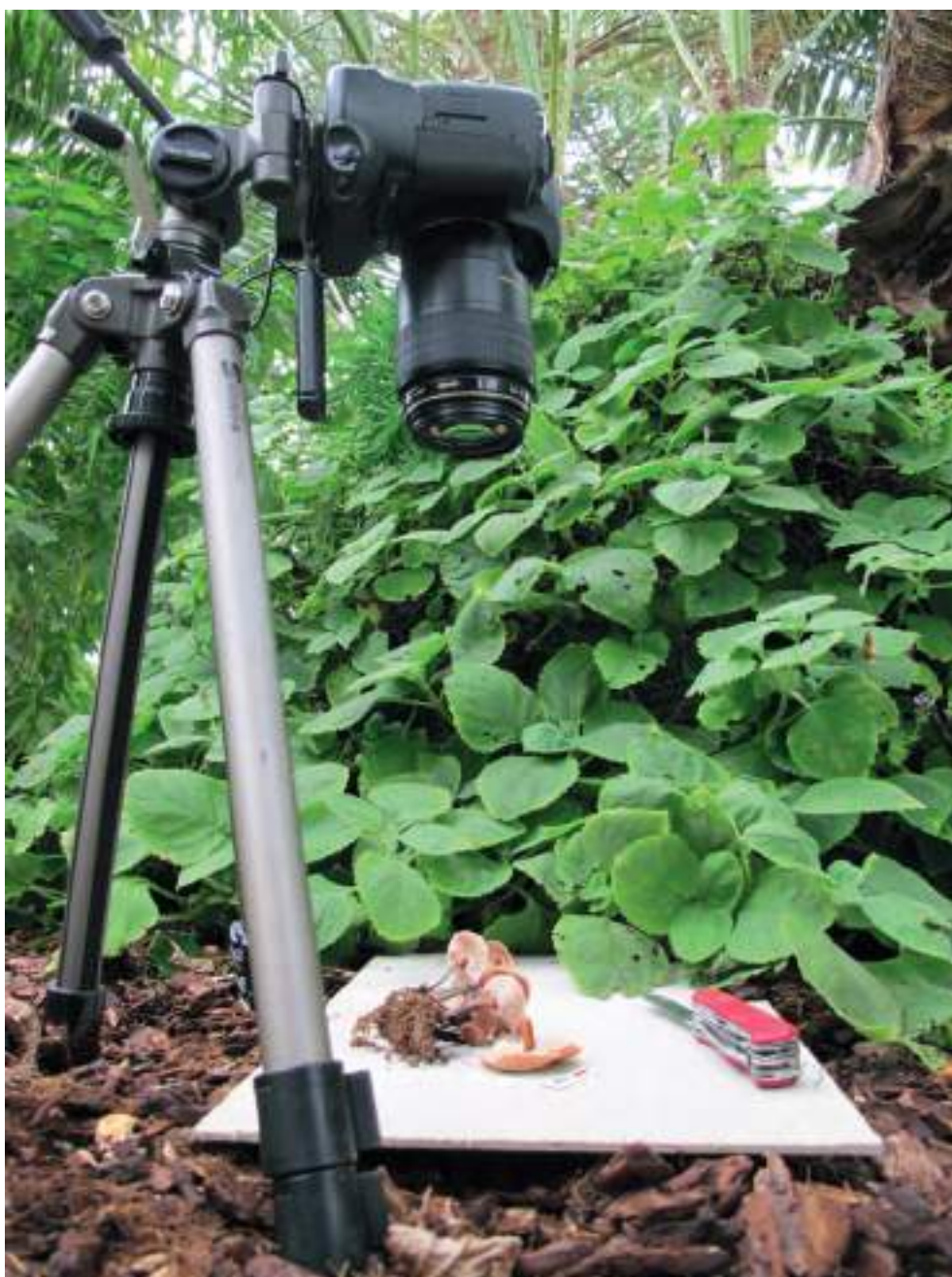
Fig. 13. Dispositif pour la réalisation d'une photographie technique. Appareil numérique reflex avec déclencheur à retardement fixé sur un trépied.
